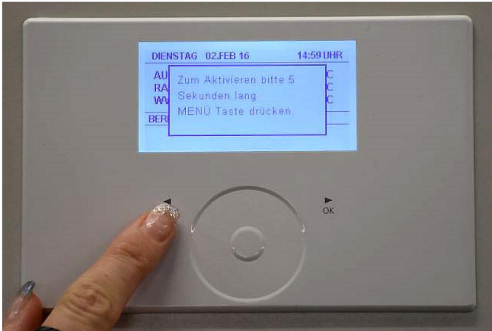
2. Streichen Sie im Bedienelement im Uhrzeigersinn, bis der Balken auf **Notbetrieb** steht. Tippen Sie danach auf **OK**.
