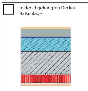
LVS: (flexibles Rundrohr DN 75)
