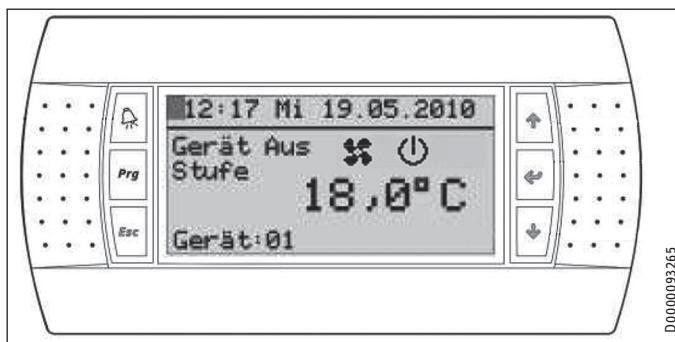
Obslužná jednotka prístroja pozostáva z displeja a 6 tlačidiel. Tlačidlo „Alarm“ hlásí vyskytujúce sa hlásenia porúch a údržby tým, že trvale svieti alebo bliká na červeno. Tlačidlo „Prg“ svieti na oranžovo pri zadaní na obslužnej jednotke a ostatné tlačidlá svietia na zeleno.
