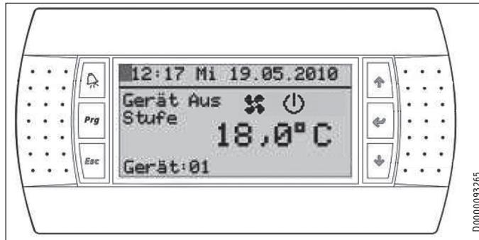
A készülék kezelőegysége egy kijelzőből és 6 nyomógombból áll. A „Alarm” nyomógomb folyamatos piros fénnel vagy villogással jelzi a hiba- és karbantartási üzeneteket. A kezelőegységbe történő beírás során a „Prg” nyomógomb narancssárgán világít, a többi gomb pedig zöldön.
