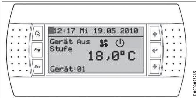
Obslužný díl přístroje se skládá z displeje a 6 tlačítek. Tlačítko „Alarm“ hlásí vzniklá hlášení o poruše a údržbě trvalým červeným světlem nebo blikáním. Tlačítko „Prg“ se rozsvítí oranžově při zadání na obslužném díle a ostatní tlačítka zeleně.
