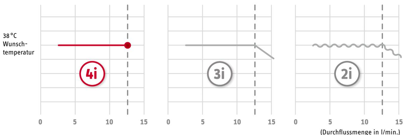
Immer konstante Warmwassertemperatur, bei Erreichen der Leistungsgrenze wird die Durchflussmenge vollautomatisch mit der maximalen Wassermenge gehalten
